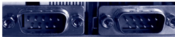
Figura Nro 56. Interfaces de Puertos serial- DB9 Macho
