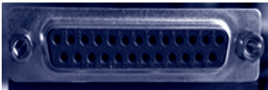
Figura Nro 57. Interface de Puerto Paralelo-DB25 Hembra
