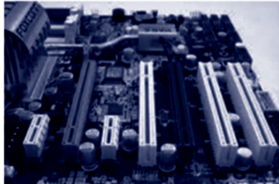
Figura Nro 54. Slots Pci Express(Rojo y Azul) PCI(Blanco)
