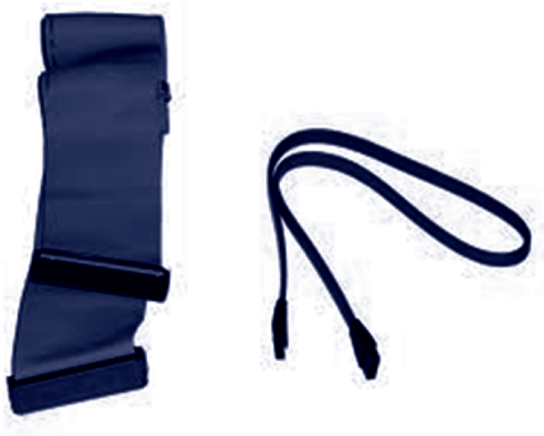
Figura Nro 60. Cables IDE y SATA
