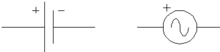
Generador de continua:  $E = \text{cte}$ . Generador de alterna sinusoidal:
