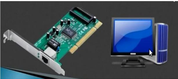
Otra forma de definir *redes de computadores*: es un sistema formado por dos, tres, cuatro o mas dispositivos ó hosts interconectados entre si a través de una tarjeta de Red. Las señales de Red se suelen transmitir, por medio de cables de Red, que son los que van conectados directamente a la tarjeta de
