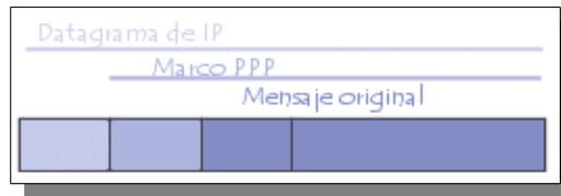
De esta manera, los datos de la red de área local (así como las direcciones de los equipos que se encuentran en el encabezado del mensaje) se encapsulan dentro de un mensaje PPP, que a su vez está encapsulado dentro de un mensaje IP.
