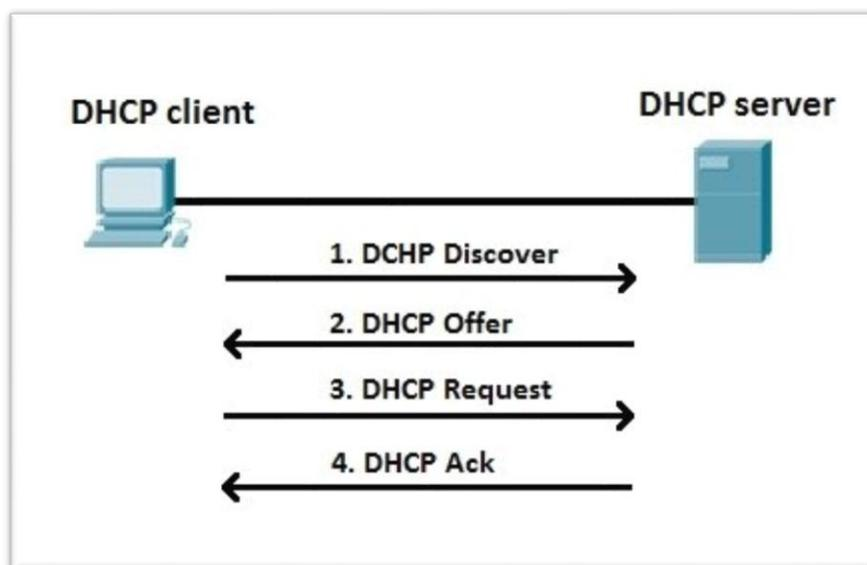
Al servidor DHCP se le pueden poner excepciones dentro del rango de direcciones IP que tiene disponibles para asignar, con el fin de que no las tenga en cuenta, porque pueden estar siendo usadas por ciertas máquinas que necesitan una dirección IP fija o estática. De este modo se evita que el DHCP asigne direcciones ya usadas dentro de la red.
