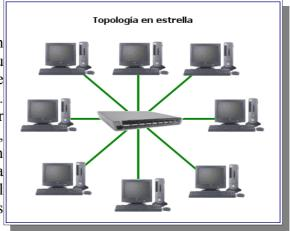
mensajes deben pasar por el hub o concentrador, el cual gestiona la redistribución de la información a los demás nodos. La fiabilidad de este tipo de red es que el malfuncionamiento de un ordenador no afecta en nada a la red entera, puesto que cada ordenar se conecta independientemente del hub, el costo del cableado puede llegar a ser muy alto. Su punto débil consta en el hub ya que es el que sostiene la red en uno.
