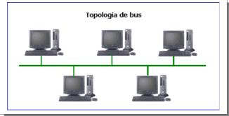
enlace y no tiene ninguna otra conexión entre nodos. Físicamente cada host está conectado a un cable común, por lo que se pueden comunicar directamente, aunque la ruptura del cable hace que los hosts queden desconectados.
